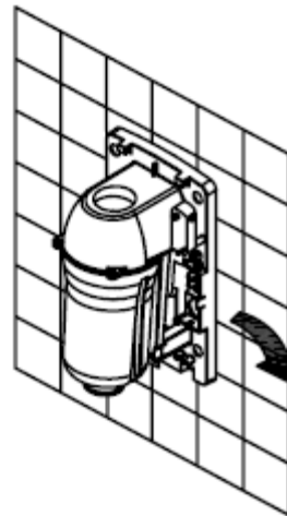
Ubicazione della morsettiera e del foro Ø 22 mm. per l'ingresso dei cavi
