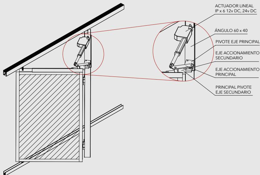
**COMPONENTES FOLDING MOTORIZADO DETALLE ACTUADOR LINEAL INSTALADO, VISTA EN CORTE LATERAL**
