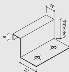
CLIP + SOPORTE DESLIZANTE, SEGÚN PANEL SEGÚN SL
