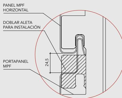
Nota: Si se endereza la aleta del portapanel después de la instalación, el panel no se puede desmontar.
