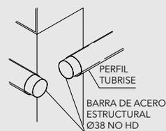
Nota: Considerar barra de acero estructural ø38 en el interior del perfil Tubrise en el inicio y término del tejido para soportar la tensión del fleje. Esta solución se utiliza si el proyecto lo requiere.
