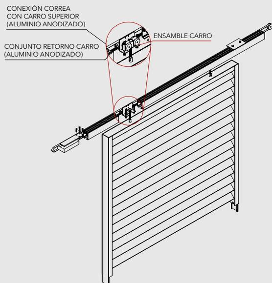
**MÉTODOS DE FIJACIÓN DE TOP RAILS**
