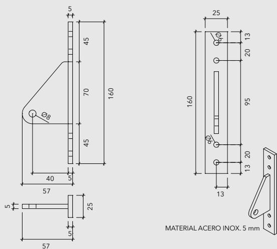
DETALLE INSTALACIÓN MOTOR A BARRA ACCIONAMIENTO
