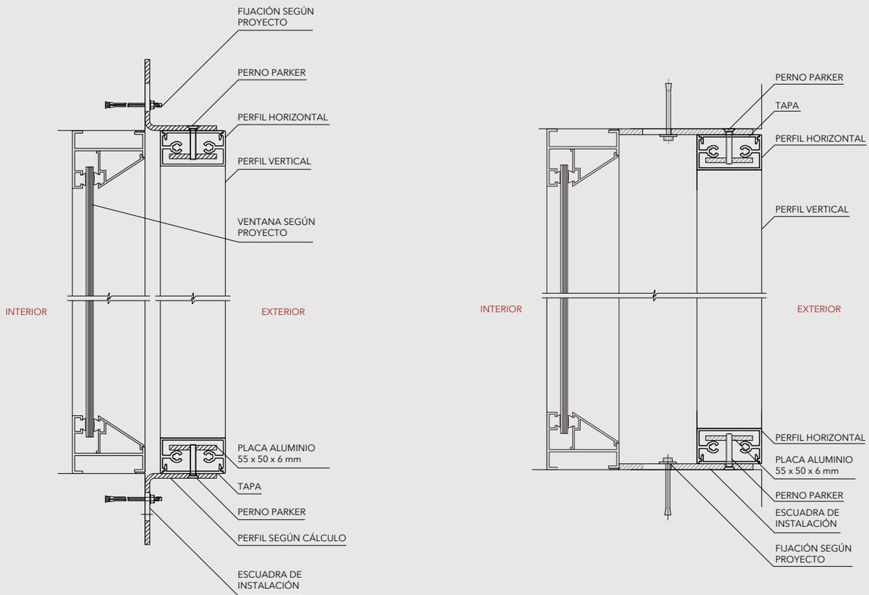
En el caso de un bastidor fijo para una correcta instalación, se recomienda considerar un pasillo técnico de mínimo 60 cm de ancho para poder limpiar ventanas por el exterior (en caso de instalación de marcos fijos y en edificios de altura).
