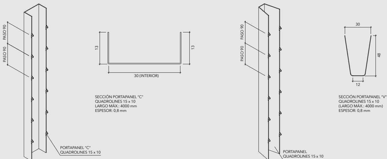
\* El panel QuadroLines 30 x 15 y 60 x 30 se fija directamente a la estructura en base a un sistema de machihembrado lo que permite una lectura homogénea, sin uniones aparentes y fijaciones a la vista.
