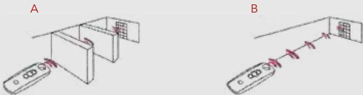
RF TELIS 1: Emisor monocanal capaz de operar solo un motor independientemente; sin embargo se pueden agregar varios motores a este monocanal funcionando todos a la vez.
