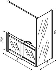
**STANDARD SHOWER ENCLOSURE FOR CORNER WITH FIXED SCREEN AND SLIDING SHORT DOOR**
