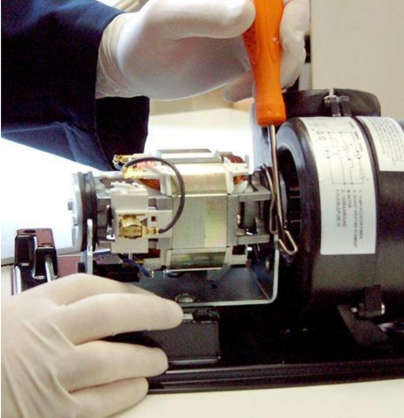
Desconectar el cable del motor que va al fusible.
