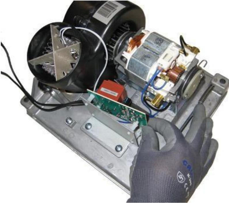
Destornillar de la placa electrónica, los cables de la resistencia y del motor.
