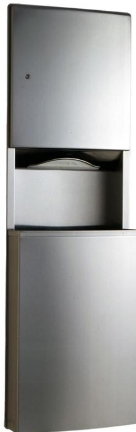
**Dispensador de toalhas de papel** - Fabricado em aço inoxidável 18-8 S tipo AISI 304, com 0.8 mm de espessura e acabamentos em aço escovado. A bandeja de toalhas arredondada tem uma abertura boleada para dispensar toalhas sem rasgar. Capacidade para 600 toalhas de papel dobradas em C, ou 800 dobradas em ziguezague.
