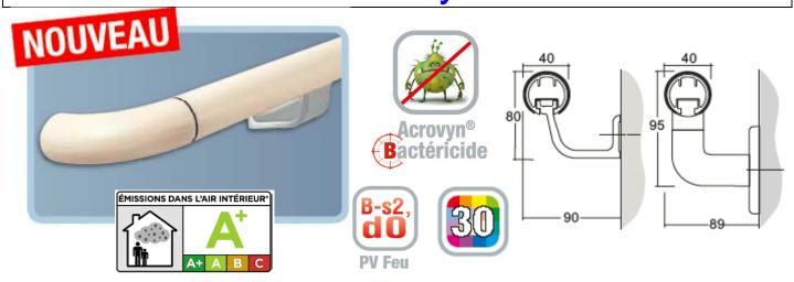
Fourniture et pose de mains courantes MCE 40/45 Acrovyn Bactéricide de chez CS France, d'un diamètre de 40mm, et d'un encombrement de 80 x 90mm ou 95 x 89mm.
