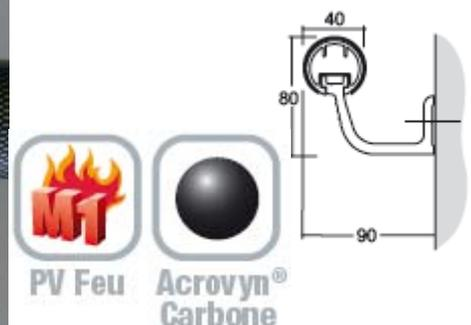
Fourniture et pose de mains-courantes MCE 40/45 Acrovyn Carbone de chez C/S FRANCE, d'un diamètre de 40mm, et d'un encombrement de 80 x 90mm.
