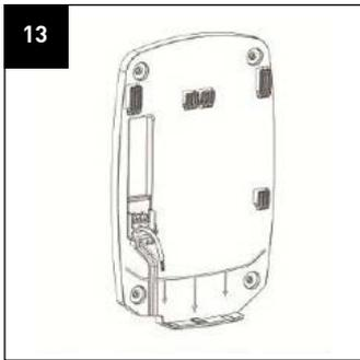
Passar os cabos através do Plug-in da base conforme demonstrado na imagem.
